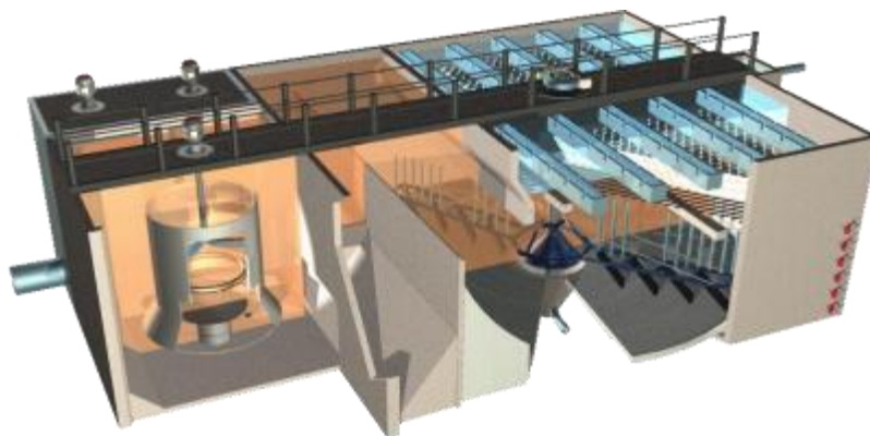
图 2-7 高效沉淀池结构示意图
