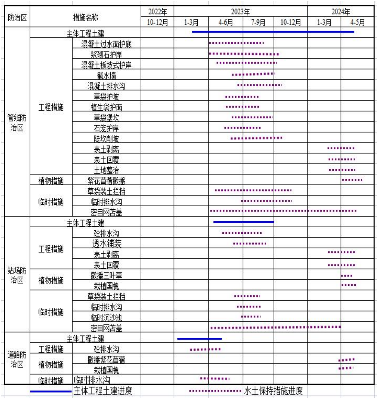
图 5-2 水土保持工程实施进度横道图
