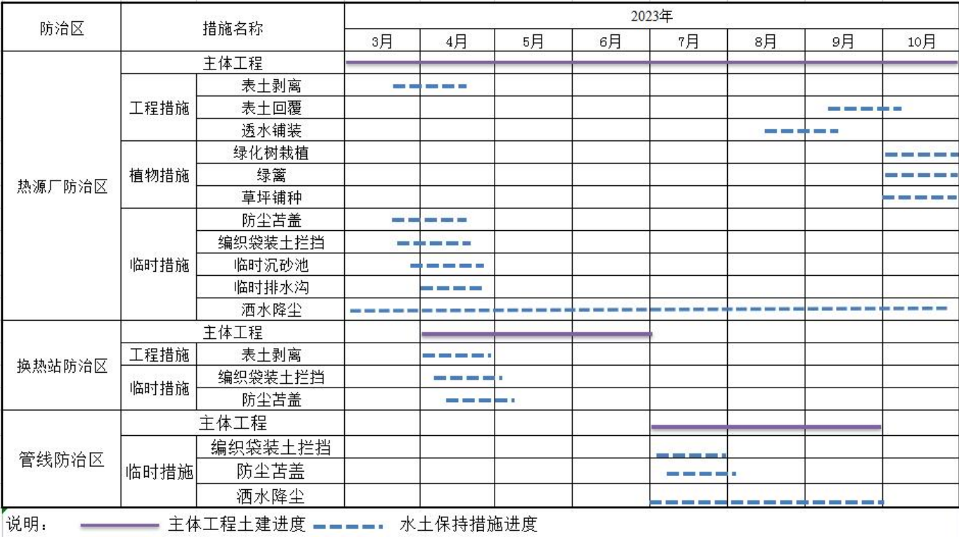
图 5-2 水土保持工程实施进度横道图
